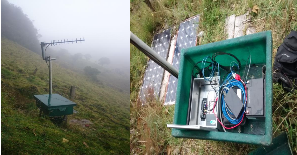
Figura 93. Digitalización estación de corto periodo CAJONES.
