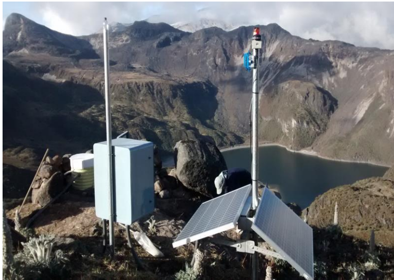
Figura 112. Instalación estación sismologica LAGUNA VERDE. Volcan Nevado de Santa Isabel.
