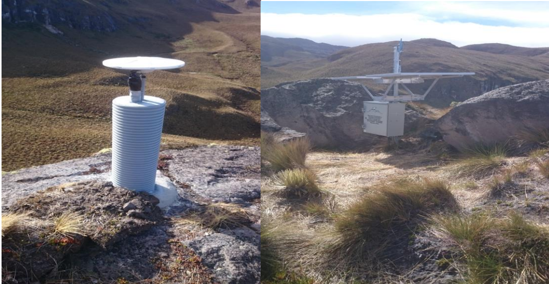
Figura 114. Instalación estación GPS OTUN. Volcán Nevado de Santa Isabel.
